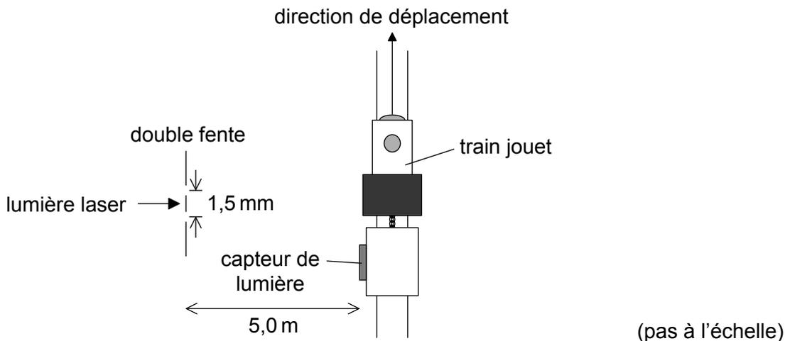
Une lumière provenant d'un laser est incidente sur une double fente. La lumière provenant des fentes est détectée par un capteur de lumière attaché au train.
