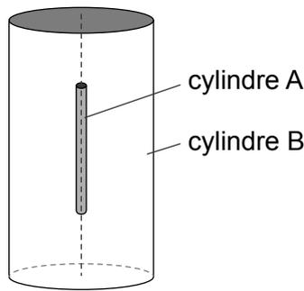
Au début de cette expérience, tout l'air fut enlevé du cylindre B. Les particules alpha se combinèrent avec les électrons tandis qu'elle traversaient la paroi du cylindre A pour former de l'hélium gazeux dans le cylindre B.
